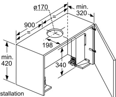
L'installation d'une hotte tiroir de 90 cm dans un meuble haut d'une largeur de 90 cm requiert un kit d'installation. Les deux équerres d'installation sont vissées à droite et à gauche dans le meuble. Installation selon gabarit.
