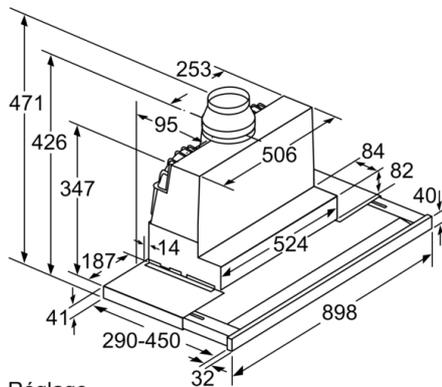
Réglage de la profondeur du tiroir-filtre possible jusqu'à 29 mm
